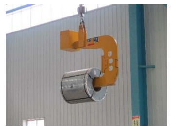
吊车搬运 (母材)
